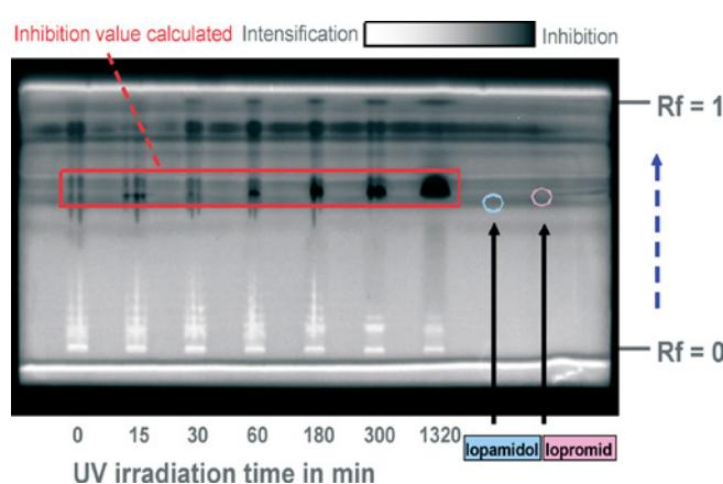
废水处理过程中的 x 射线造影剂在紫外光照射下会产生辐射，TLC / HPTLC 与生物活性检测图像显示了该作用下产生的降解产物的生物活性作用。从照片中可以看出，增加照射时间生成物质的独特生物荧光细菌的抑制作用增强。然而，在试管试验中，这种降解产物的抑制作用会被掩盖。
