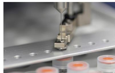
ATS 4 可加热喷嘴，降低大体积及难挥发点样溶剂的影响
